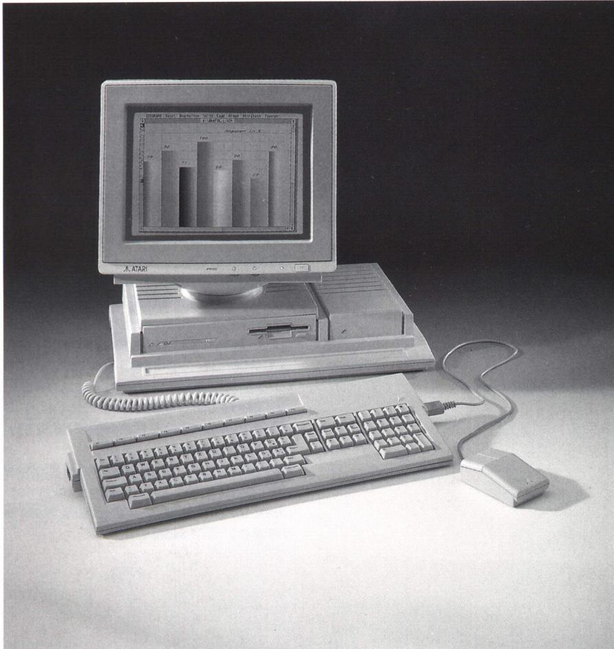
Seine mit 32 MHz getaktete 32-Bit Zentraleinheit MC 68030 gibt dem TT zusammen mit dem mathematischen Koprozessor MC 68882 die Rechenleistung für anspruchsvollste Aufgabenstellungen. CAD, Bildverarbeitung und Desktop-Publishing von höchster Komplexität sind nur einige Beispiele. Mit seinem bis auf 26 MB erweiterbaren Hauptspeicher und den internen Festplatten mit 40 und 80 MB werden selbst umfangreiche Datenmengen bearbeitet bzw. gespeichert.
